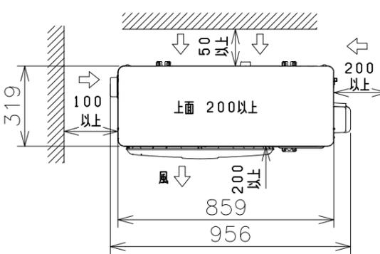
ベランダ等の室外機周囲に壁がある場合への据付けは、上面側と側面又は正面の2方向以上を開放した上で、下図の必要寸法以上を確保してください。
