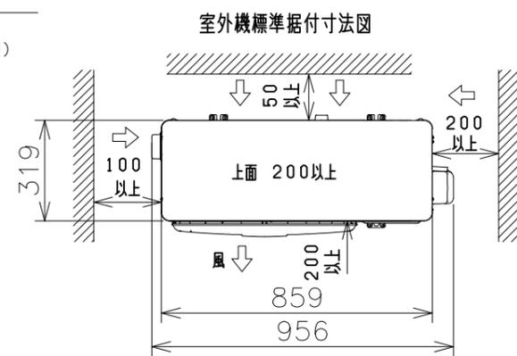
ベランダ等の室外機周囲に壁がある場合への据付けは、上面側と側面又は正面の2方向以上を開放した上で、下図の必要寸法以上を確保してください。
