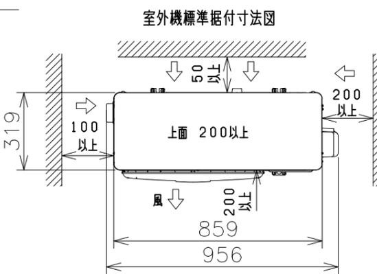
ベランダ等の室外機周囲に壁がある場合への据付けは、上面側と側面又は正面の2方向以上を開放した上で、下図の必要寸法以上を確保してください。
